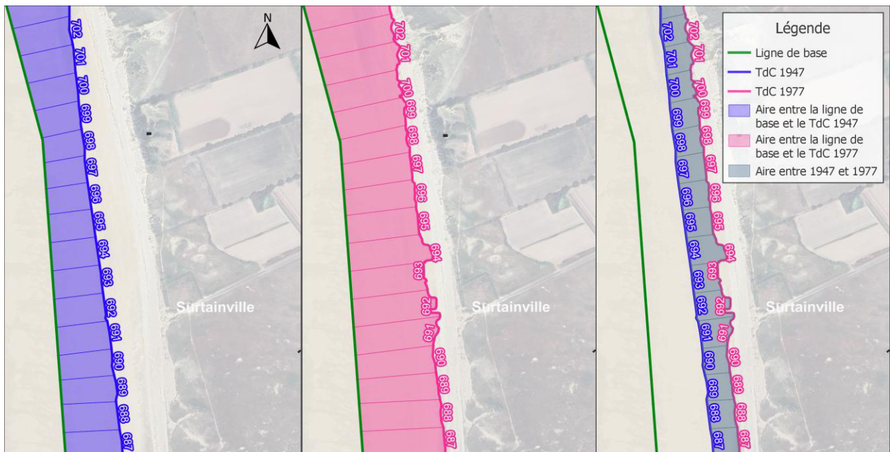
FIGURE 7. ILLUSTRATION DE LA METHODE DES AIRES.
