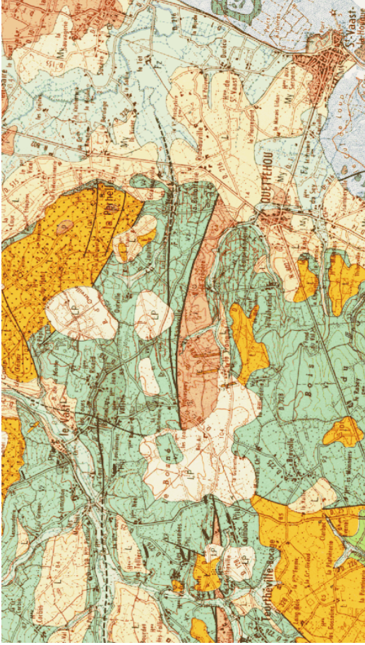
Figure 9 : Faille Est-Ouest à Quettehou – Carte géologique au 1/50 000ème
